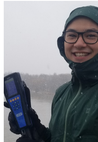
Personnel utilisant une sonde de la qualité de l'eau pour prendre une mesure ponctuelle.
